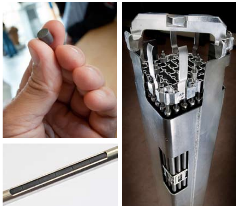
Figur 4 - 6. Fotografierna visar en enskilda uranbränslekuts med 8 mm diameter, ett kapslingsrör av zircaloy med urankutsar och del av ett fyra meter långt bränsleelement. Röret och bränslelementet har skurits upp av pedagogiska skäl. Foto Fredrik Ekenborg.
