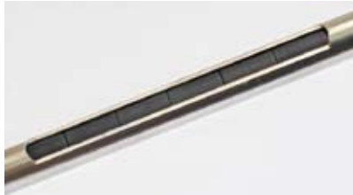
Figur 4 - 6. Fotografierna visar en enskilda uranbränslekuts med 8 mm diameter, ett kapslingsrör av zircaloy med urankutsar och del av ett fyra meter långt bränslelement. Röret och bränslelementet har skurits upp av pedagogiska skäl. Foto Fredrik Ekenborg.
